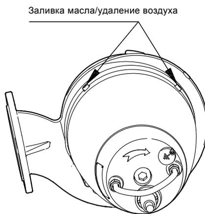
Рис. 5 Отверстия для заливки масла
