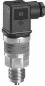
Датчик давления MBS 3000 предназначен для измерения давления жидкостей и газов в промышленности. Используется с Е-насосами, СUE, шкафами управления Control MPC для регулирования производительности в зависимости от давления, например, в системах повышения давления.
