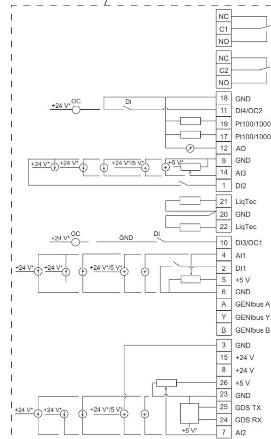
\* При использовании внешнего источника питания необходимо предусмотреть соединение с заземлением.
